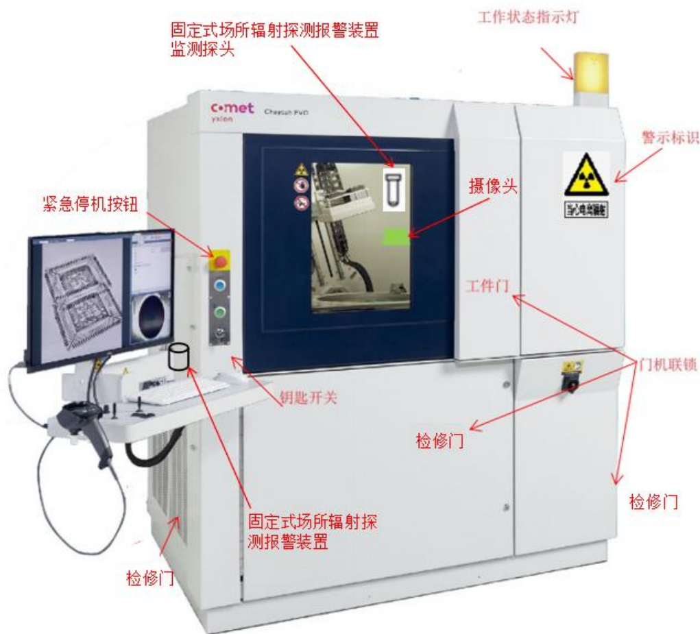
图 10-4 本项目辐射防护措施图
