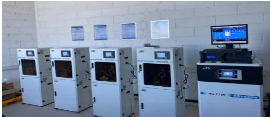
废水在线监测设备 PH、流量、COD、氨氮、总磷、总氮
