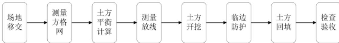
本工程主要使用反铲挖掘机进行挖土人工配合的开挖方式。土方开挖至坑底后，测量人员应及时将基槽底标高控制点和轴线控制桩引入基坑内，检查距坑边尺寸，确定基坑开挖位置和宽度，同时根据引入的控制线修整基坑四周，并将坑底铲平后清槽。
