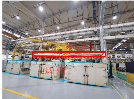
电烘干箱及废气收集管道
