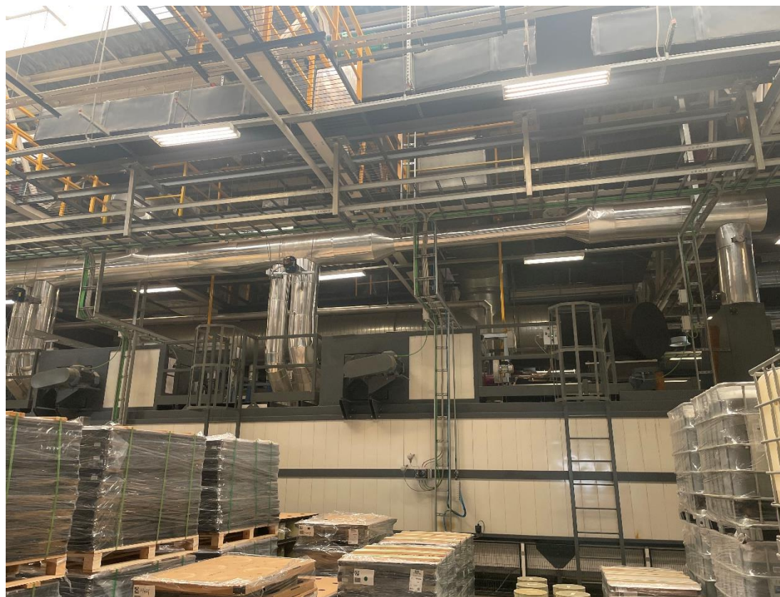
催化剂生产线（编号 2000A）分解炉及其改造的集气管线
