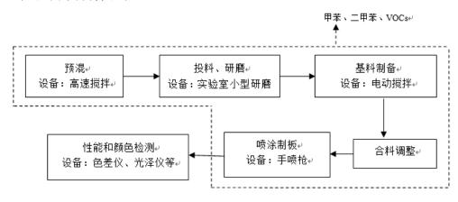
图 3-3 研发样品流程图
