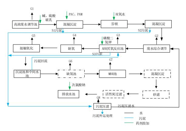
图4-4 厂区污水处理站工艺流程
