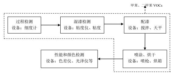
图 3-2 产品质量检测流程图
