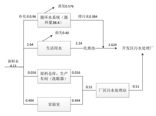
图 3-1 本项目水平衡图 (单位: m³/d)
