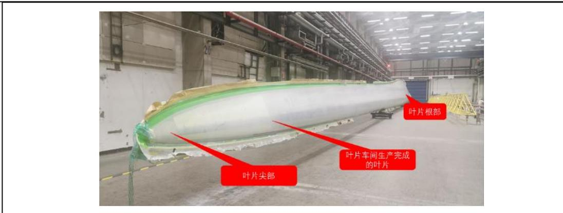
图 2-8 叶片生产示意图
