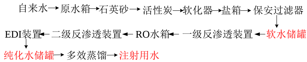
图 2-2 软水、纯化水、注射用水制备工艺图
