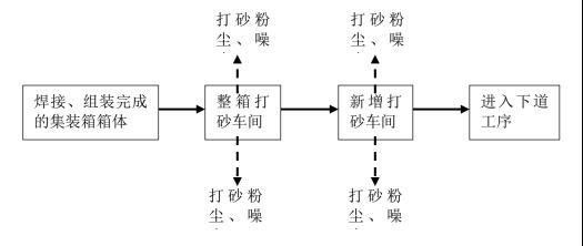
图 2-2 本项目打砂工艺流程图
