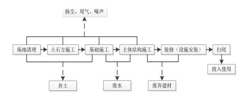
图 2-1 本项目施工期工作流程图
