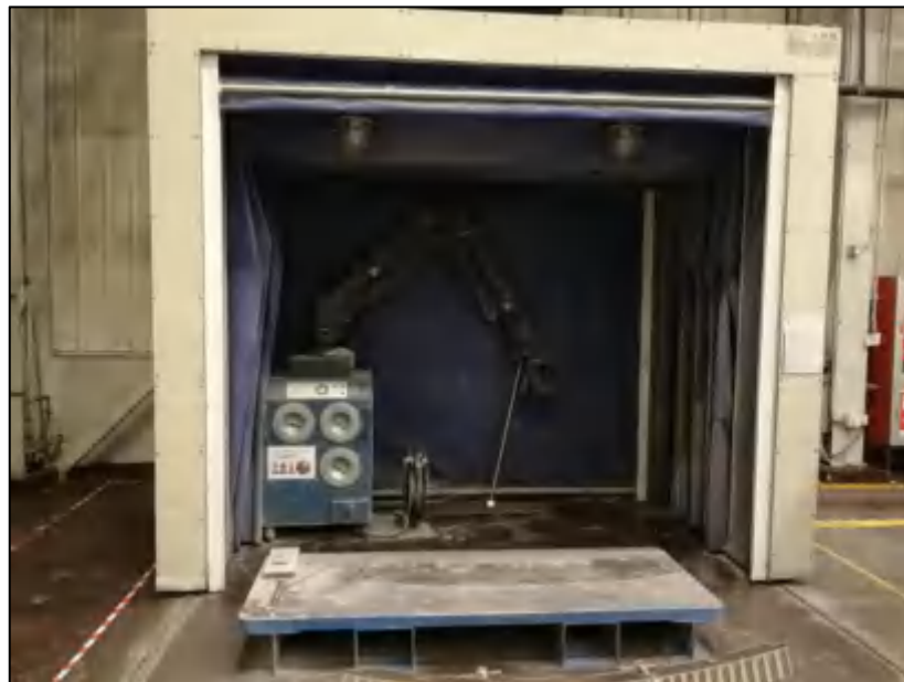
图 4.2-3 铁芯打磨工位示意图
