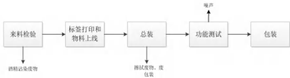
图 2.6-5 直流装置工艺及产污节点图
