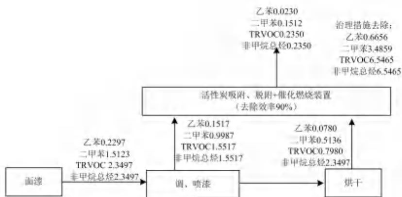
图 4.3-2 面漆工序物料平衡图（单位 kg/h）
