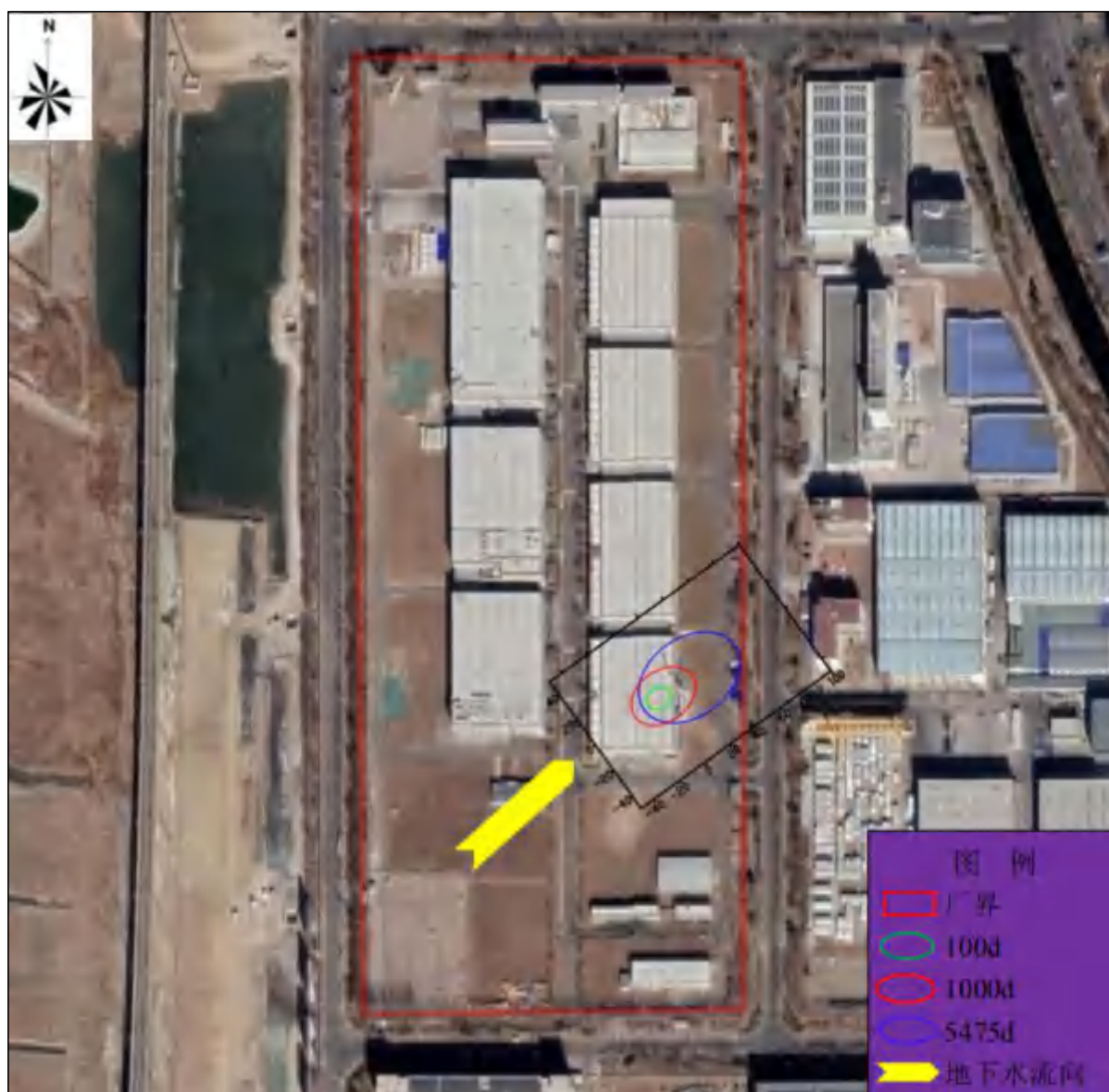
图 7.5-1 喷漆房非正常状况泄漏后二甲苯超标范围预测图
