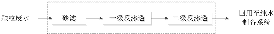
图 1 回用水处理系统处理工艺
