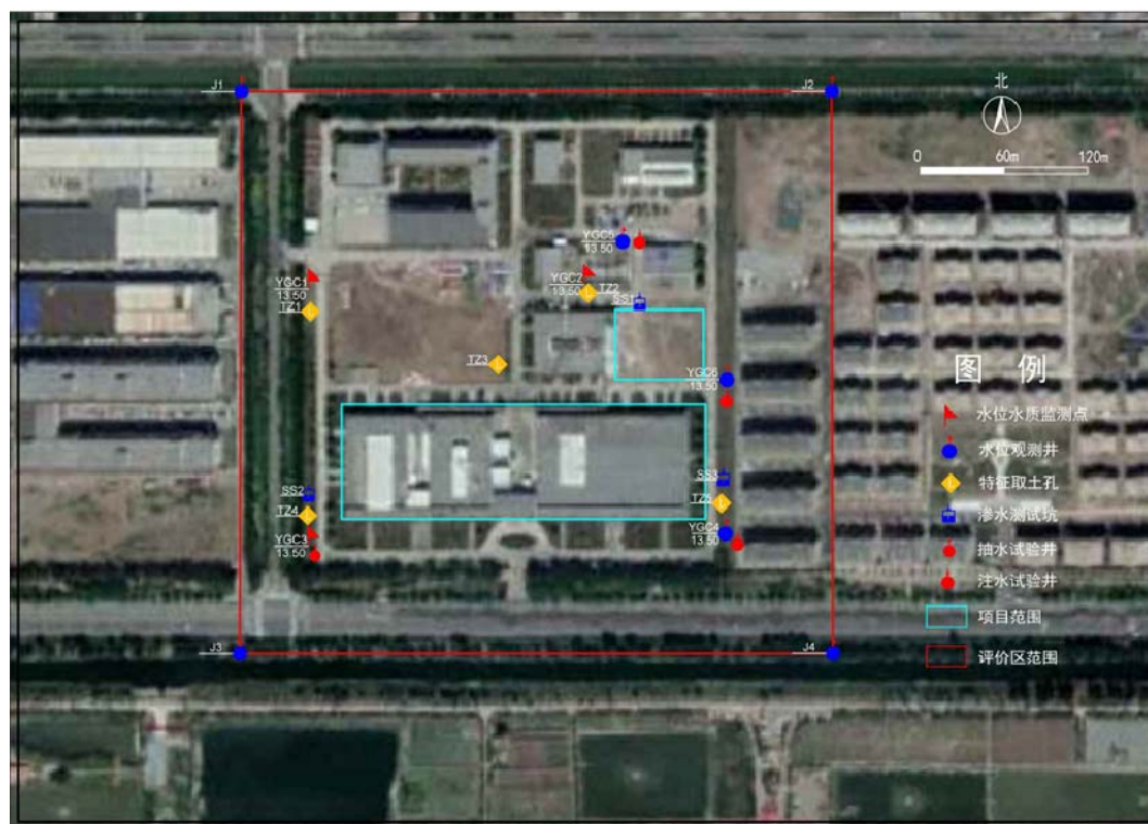
图 3.3-16 土壤、地下水现状监测点平面位置图
