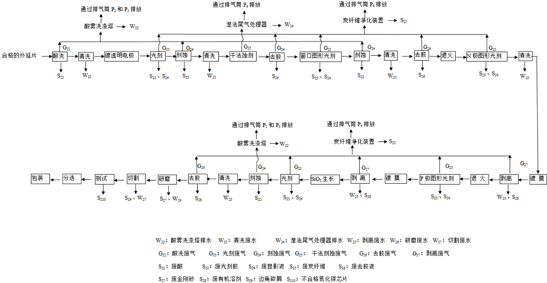
图 2.1-5 蓝、绿光芯片工艺流程图
